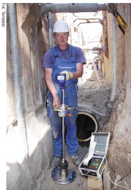
W Terratest 5000 Blu wartości pomiarów są transmitowane za pośrednictwem Bluetooth
