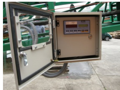
Terminal Dini Argeo zabudowany w szafce
