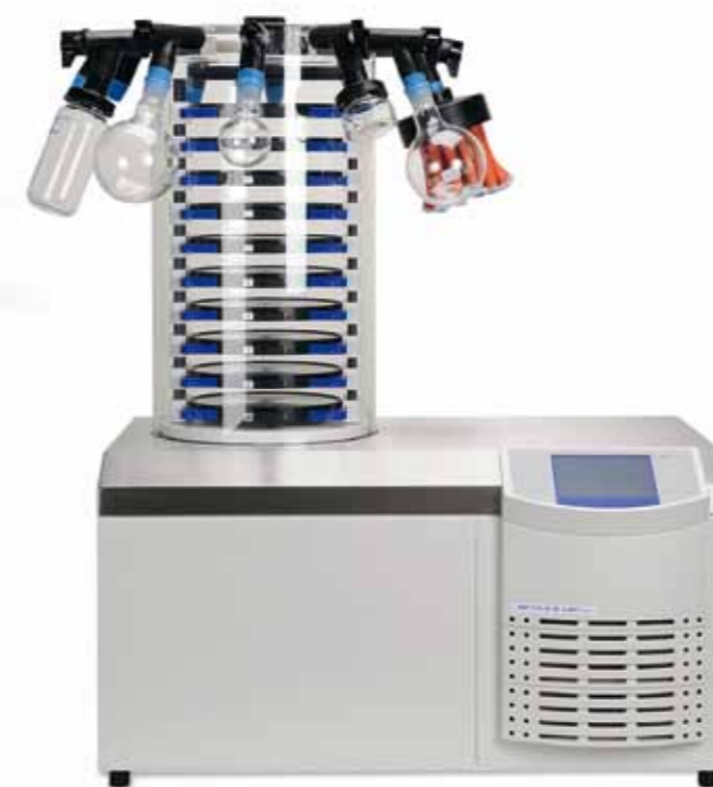
Transparente, runde Gefrier-trocknungskammer aus Ø 300 mm Rohr mit oben dicht aufgeklebtem Deckel aus 40 mm PLEXIGLAS®.
