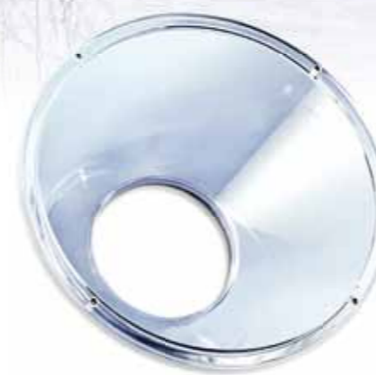
Industrieller PLEXIGLAS®-Fülltrichter aus handgeformten und geklebten Seitenwänden und CNC-bearbeiteten geklebten Flanschen, eng-toleriert. Abmessung ca. 550 x 250 x 300 mm.
