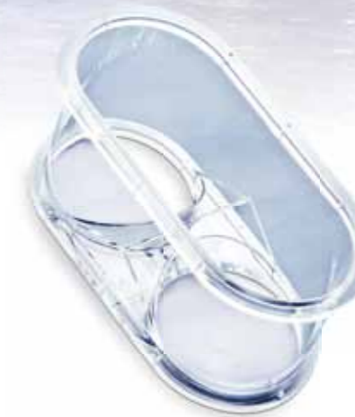
Kundenspezifischer PLEXIGLAS®-Doppelfülltrichter mit engsten Toleranz-Vorgaben aus handgeformten und geklebten Seitenwänden und CNC-bearbeiteten geklebten Flanschen. Abmessung ca. 700 x 280 x 300 mm.
