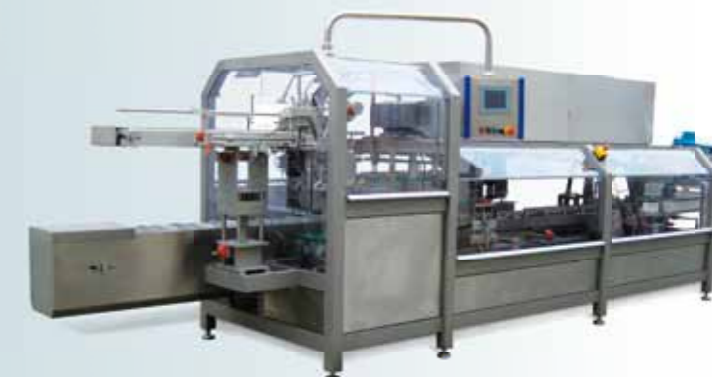
Maschinenverkleidung aus rahmen- losen Flügeltüren aus 12 mm MAKROLON®- Polycarbonat-Scheiben, kalt-gekantet.
